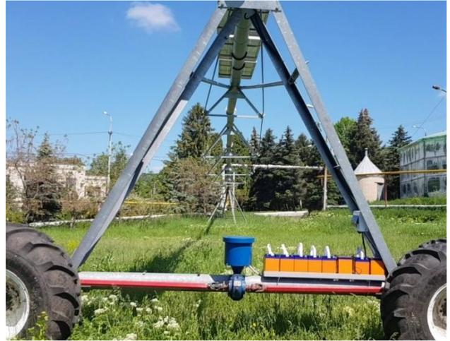
Рисунок 39 – Аккумуляторный способ питания ДМ с использованием солнечных батарей на предприятии УНПК «Агроцентр» СГАУ
